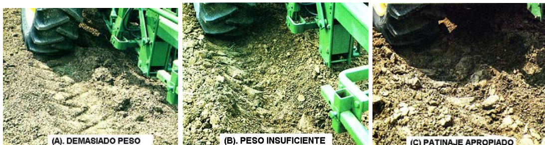
Figura 8. Las huellas de un tractor cargado que muestran diferentes valores de patinaje. La lectura de estas en el suelo nos puede mostrar que objeto las hizo. Las ruedas o llantas de otros implementos de tiro, como las sembradoras, también presentan patinaje, lo que puede afectar la calibración. Fuente: adaptado de John Deere Service Publ., 1976.
